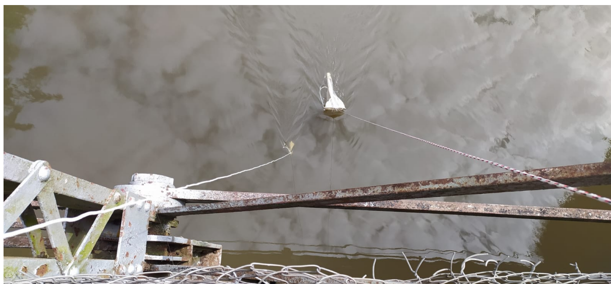
Figura 10 – Fotografia da amostragem teste realizada no rio Atibaia, com o fluxômetro (a esquerda) e rede (a direita) sendo içado de uma ponte sobre o rio.
