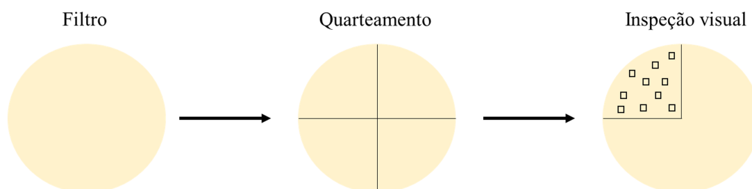
Figura 9 – Esquema de quarteamento de filtro utilizado para a contagem de microplásticos. Adaptado de Huppertsberg e colaboradores 78 .
