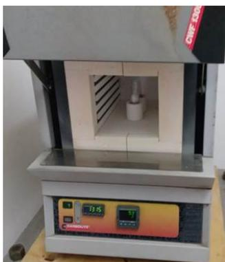
**Figura 3.3:** Forno de altas temperaturas utilizado no processo de síntese
