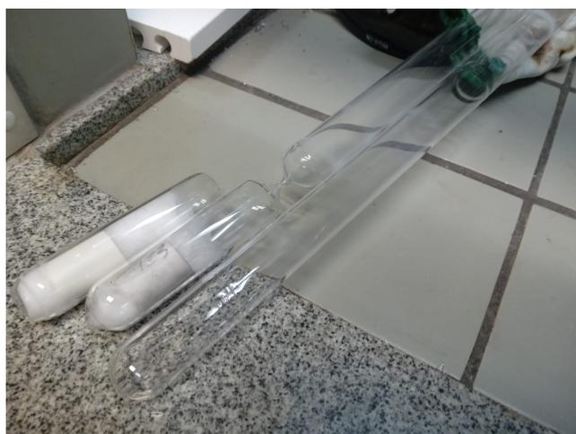
**Figura 3.2:** Tubos de quartzo em diferentes estágios do processo de selagem à vácuo utilizado
