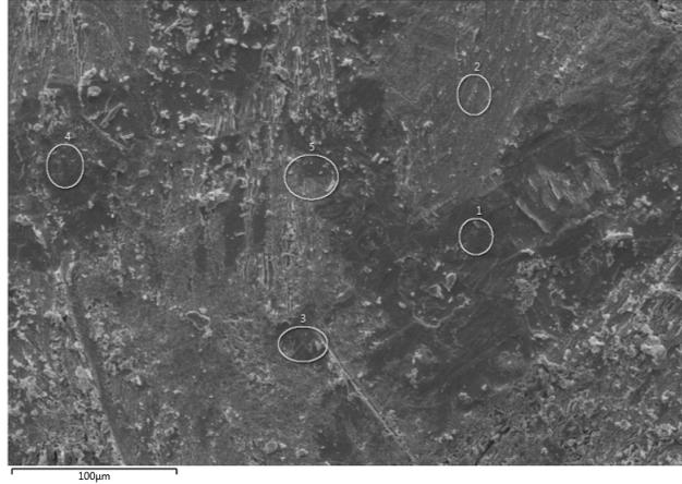
**Figura 4.5:** Imagem de microscopia eletrônica de áreas analisadas através da técnica de EDS em um monocristal de  $TbCuBi_2$  lixado.
