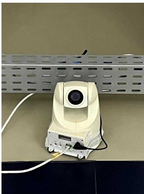
Figura 3.6 – Sistema para detecção da pose via ArUco. Fonte: Autor
