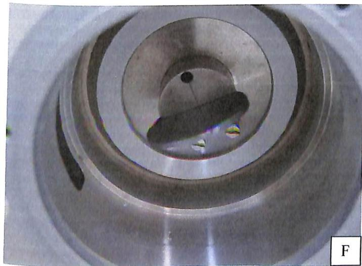
Em A o material para preparação de amostras para difratometria. Utiliza-se uma peneira com malha de 300 mesh e pincel para a aplicação da amostra pulverizada sobre suporte de cristal de silício D e E. Na imagem F o porta amostra colocado no interior da câmara do difratômetro. Em B temos o monocromador de grafite responsável pela filtragem adicional do feixe difratado aumentando a relação sinal-ruído no detector.
