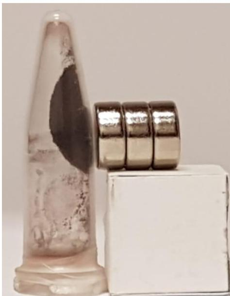
**Figura 43** – Atração magnético entre o **Fe-pvb** e o conjunto de imãs.
