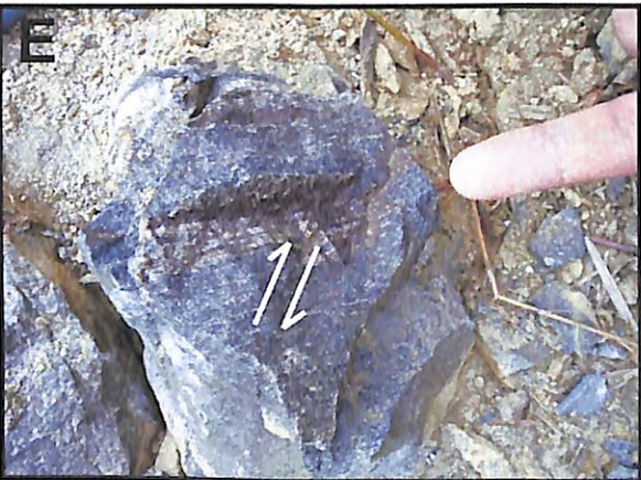
Figura 3.1: A) Foliação em zona de transcorrência. B) Estiramento mineral mostrando a direção de movimento nessa zona. C) K-feldspato, preenchendo fraturas nos gnaisses do embasamento. D) Porfiroblastos de K-feldspato em gnaisses bandados. E) Falha Transcorrente Dextral em gnaisse (N50W/80SW).
