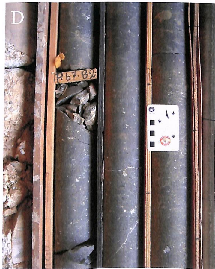
Exo II - Furos de sondagem do kimberlitos Galeria (Coromandel, MG). Notar aspecto brechado e presença de enólitos de rochas encaixantes nas amostras de facies diatreme (23,06 m de prof.) (A e C) e aspecto maciço e coloração escura nas amostras de facies hipoabissal (67, 82 m de prof.) (B e D).
