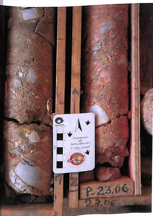
Exo II - Furos de sondagem do kimberlitos Galeria (Coromandel, MG). Notar aspecto brechado e presença de enólitos de rochas encaixantes nas amostras de facies diatreme (23,06 m de prof.) (A e C) e aspecto maciço e coloração escura nas amostras de facies hipoabissal (67, 82 m de prof.) (B e D).
