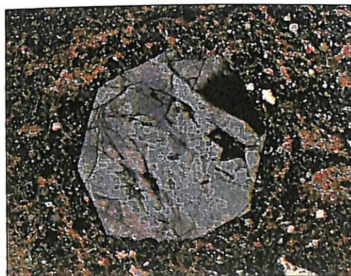
Figura 18. Fotomicrografia de Quartzo Bipiramidal
