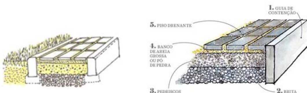
Figura 29: Esquematização de pisos drenantes
