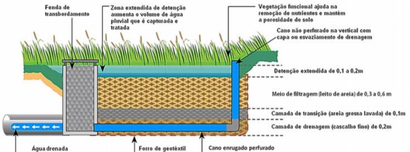
Figura 5: Seção de uma Bacia de Biorretenção
