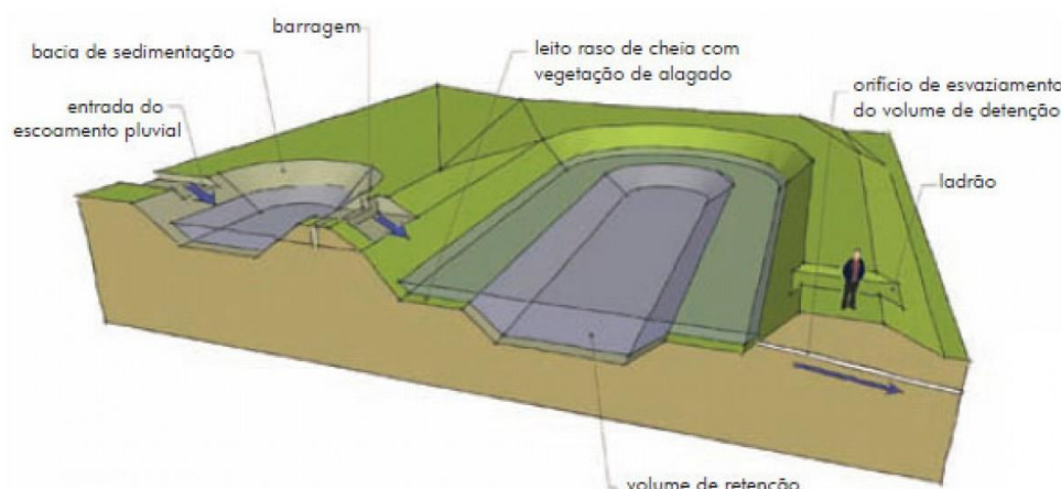
Figura 40: Esquematização de implantação de água pluvial
