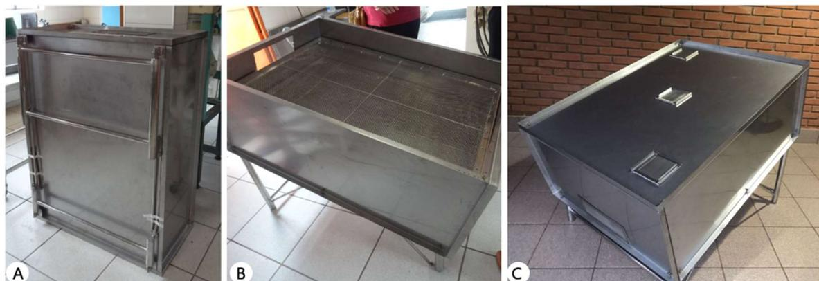
**Figura 2.** Secador solar utilizado neste projeto, sendo A = parte de baixo; B = lateral esquerda; e C = frente e lateral direita
