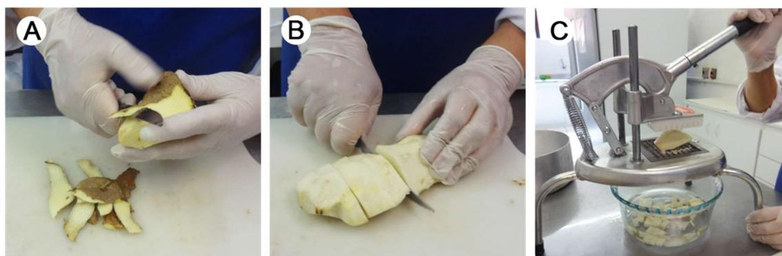
**Figura 5.** Etapas de descascamento (A) e corte (B e C) no processamento de cará-de-espinho em farinha
