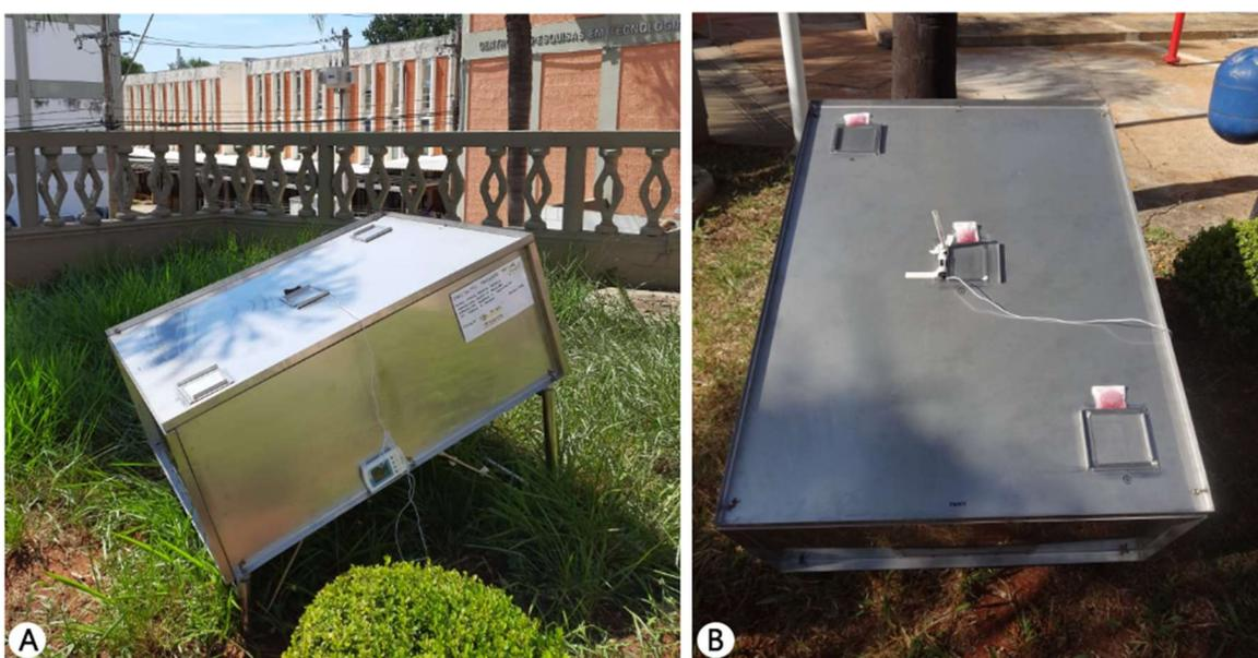
**Figura 4.** Secador solar ao sol, sendo A = com termômetro na parte superior central e termohigrômetro com visor na lateral e B = sílicas nas direções que foram colocadas no interior do secador
