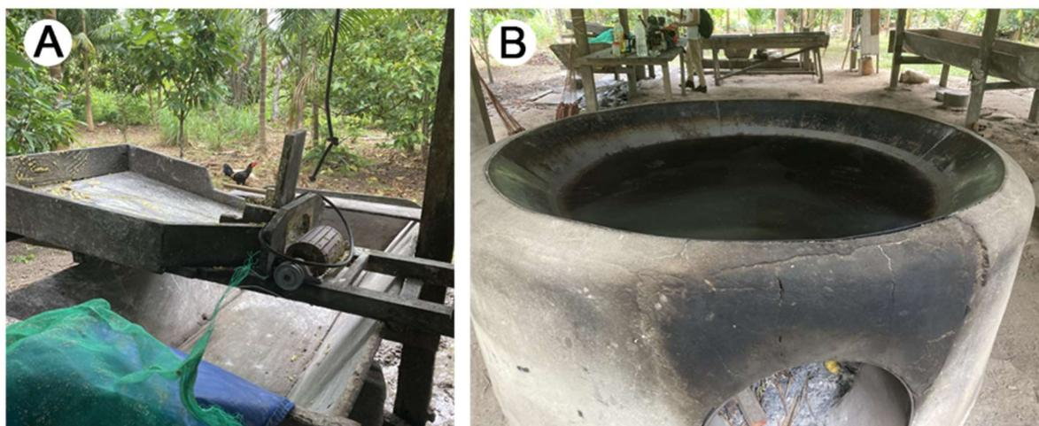
**Figura 1.** Tecnologias da casa de farinha utilizadas para a produção de farinha de mandioca, sendo A = moedor e B = forno com chapa (secagem da massa), encontradas no município de Caapiranga (AM)
