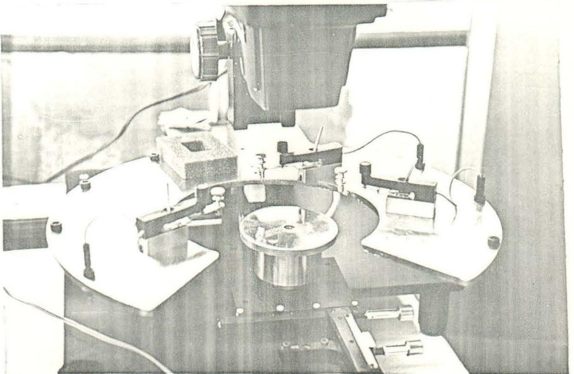
Figura III.25(b) - Mesa do sistema multipontas em mais detalhes.
