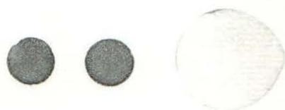
Figura III.31 - Amostras de silício que serão caracterizadas pela espectrometria infravermelha, juntamente com uma amostra de referência.
