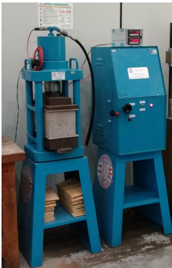
Figura 10: Ensaio de resistência à compressão em bloco de concreto (Fonte: Autor)
