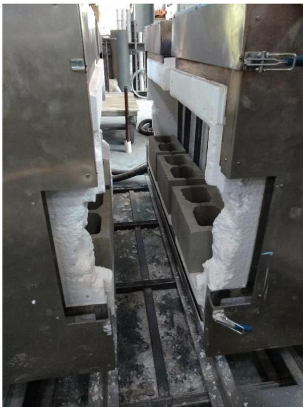
Figura 8: Blocos de concreto dispostos no forno elétrico (Fonte: Autor)
