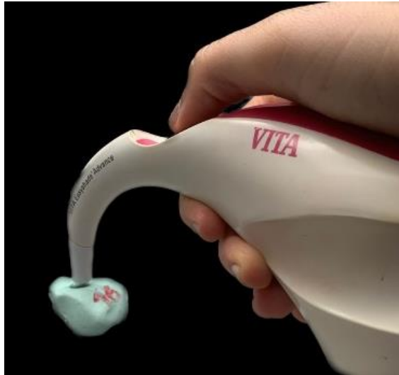
Figura 3 - Espectrofotômetro digital posicionado na matriz de silicone de condensação para avaliação da cor.
