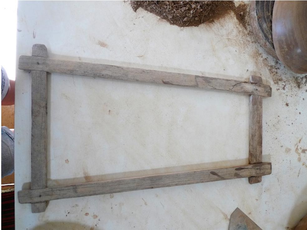
Fotografia 1 – Grade de madeira. Grade de madeira utilizada pelo Sr. Nivaldo na produção de telhas. Fonte: Autora, 21 de fev. de 2019.
