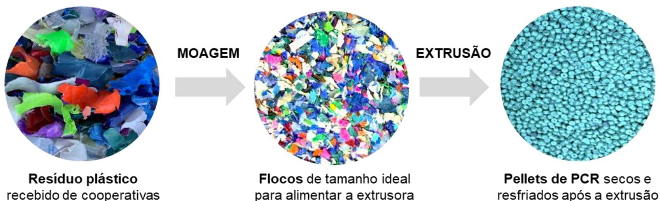
Foram recebidos de cooperativas variadas, aproximadamente, 200 kg de material por lote. Cada lote continha resíduos plásticos flexíveis ou rígidos, já limpos e pré-moídos. A limpeza dos flocos foi realizada por fricção hidromecânica em um tanque de água com um impelidor girando à temperatura ambiente e sem adição de surfactantes.
