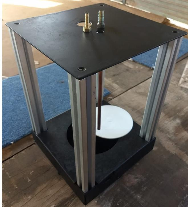
**Figura 9.** Pré-montagem com as peças em aço pintadas para evitar oxidação
