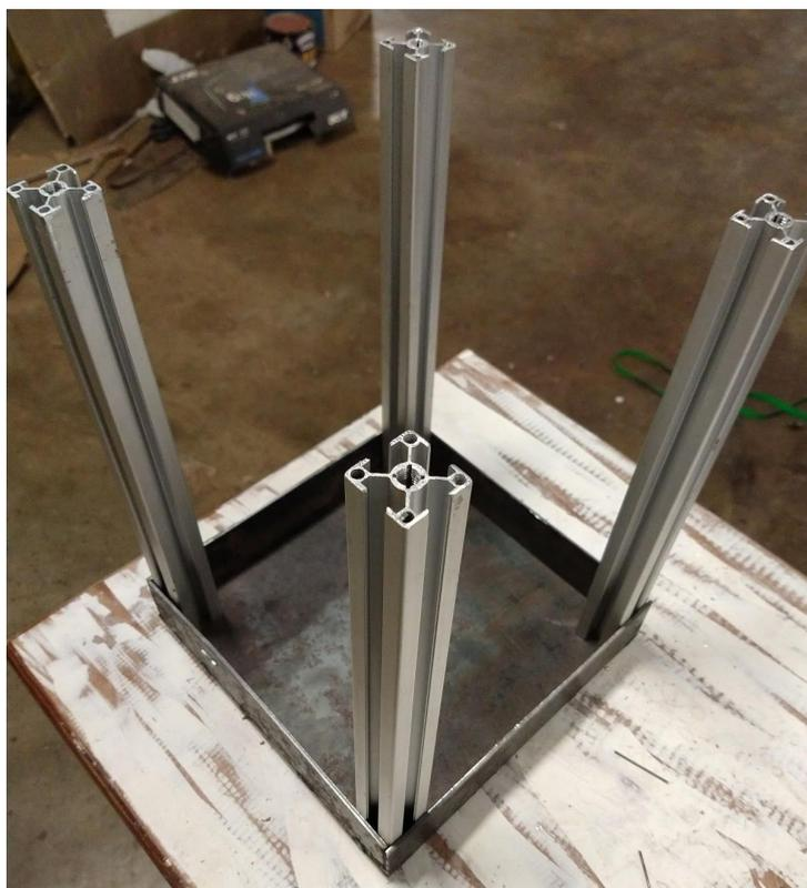
**Figura 6.** Chapas cortadas e soldadas
