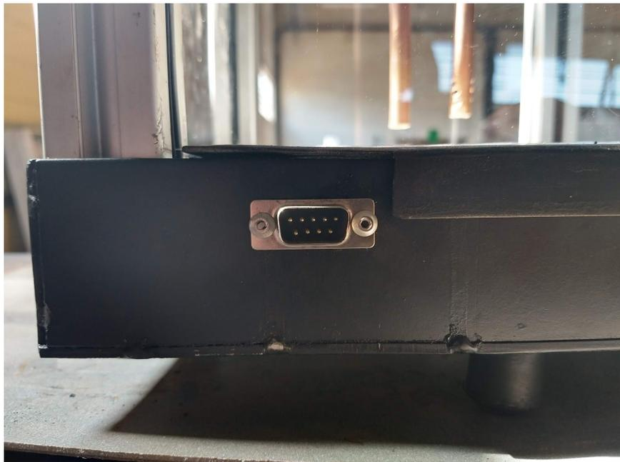
**Figura 11.** Detalhe do conector DB9 para tomada de dados
