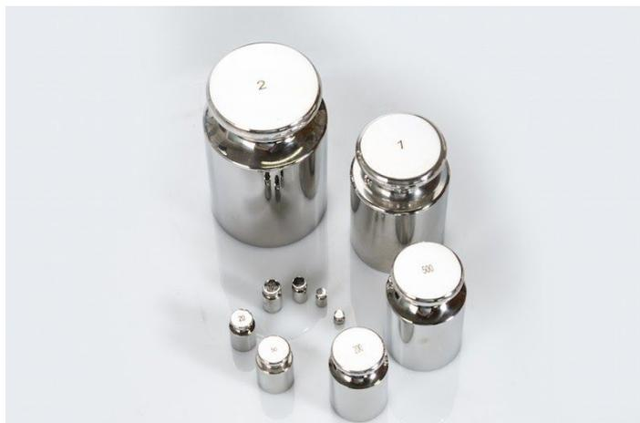
**Figura 13.** Exemplo de pesos para calibração
