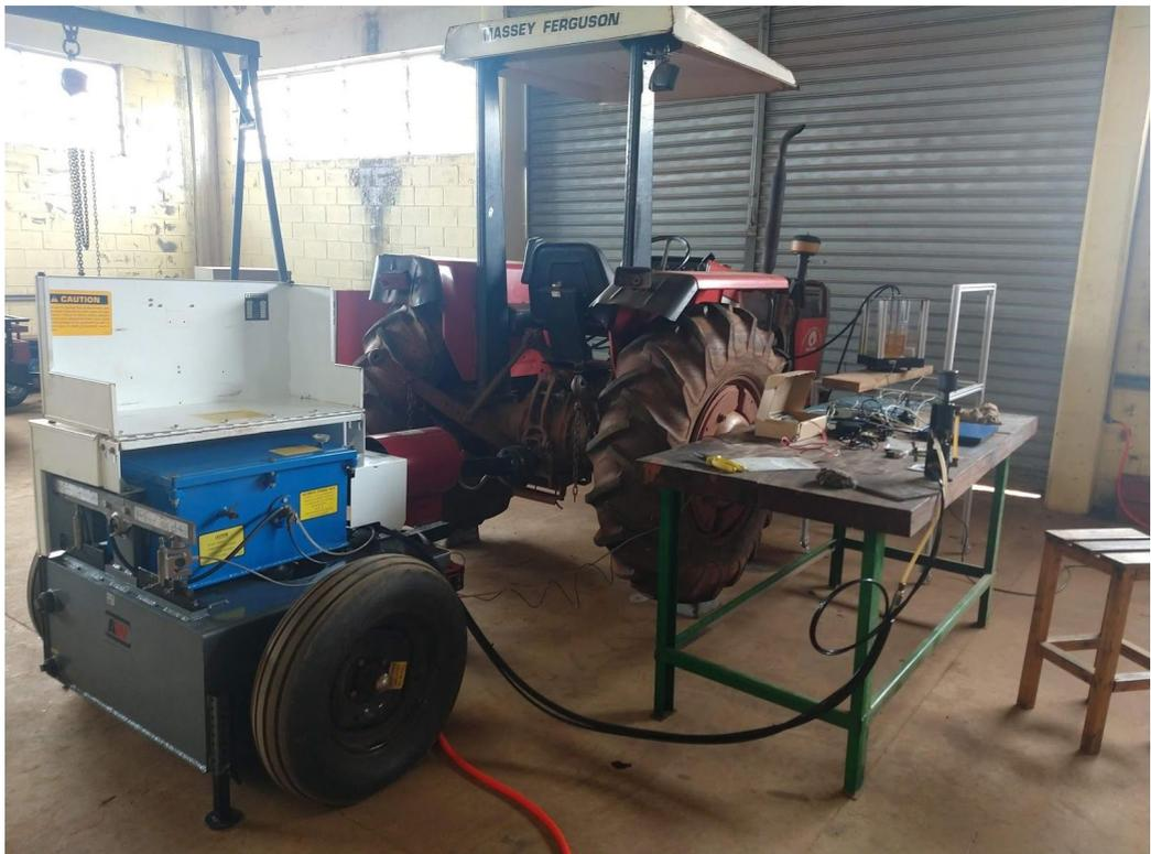
**Figura 15.** Instrumentação instalada, destaque para o dinamômetro
