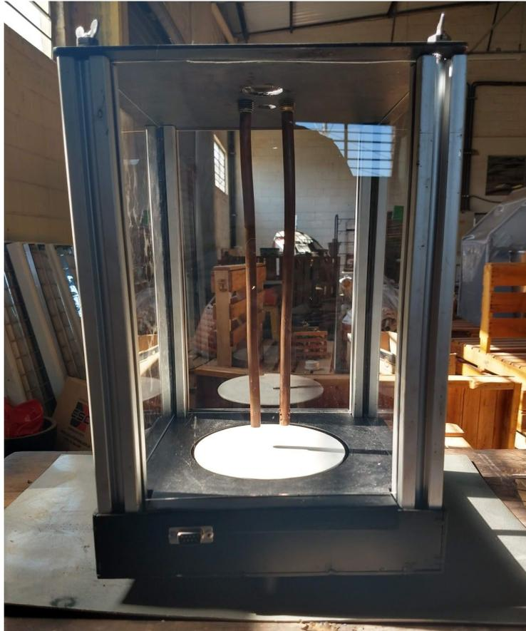
**Figura 10.** Montagem final com placas de acrílico nas laterais
