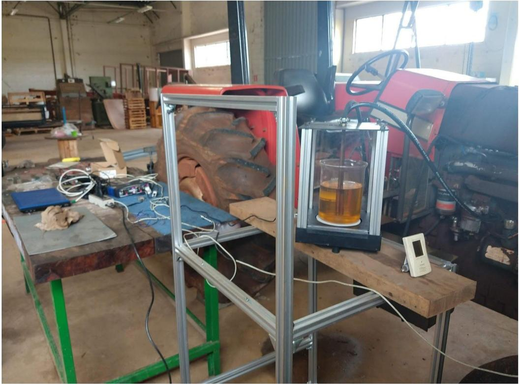
**Figura 14.** Instrumentação instalada, destaque para o fluxômetro
