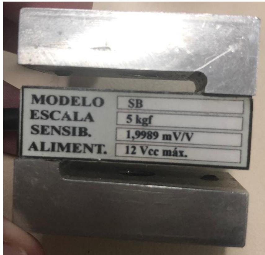
Figura 2. Detalhe das especificações do sensor
