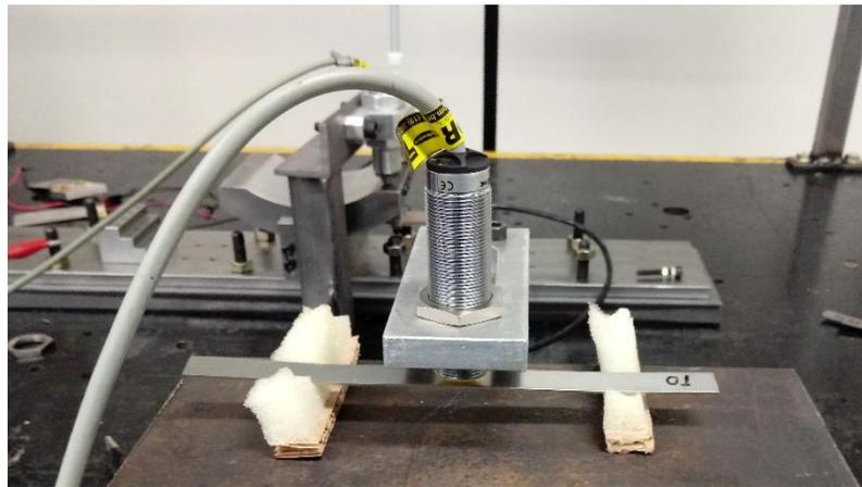
Figura 3.14. Montagem experimental, com base na norma ASTM E1879 – 09, para a determinação do módulo de elasticidade das molas planas dos suportes de mancal.
