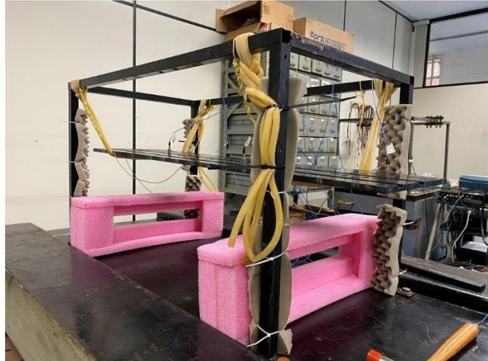
Figura 3.7. Bancada de análise modal para configurações de vibração livre.
