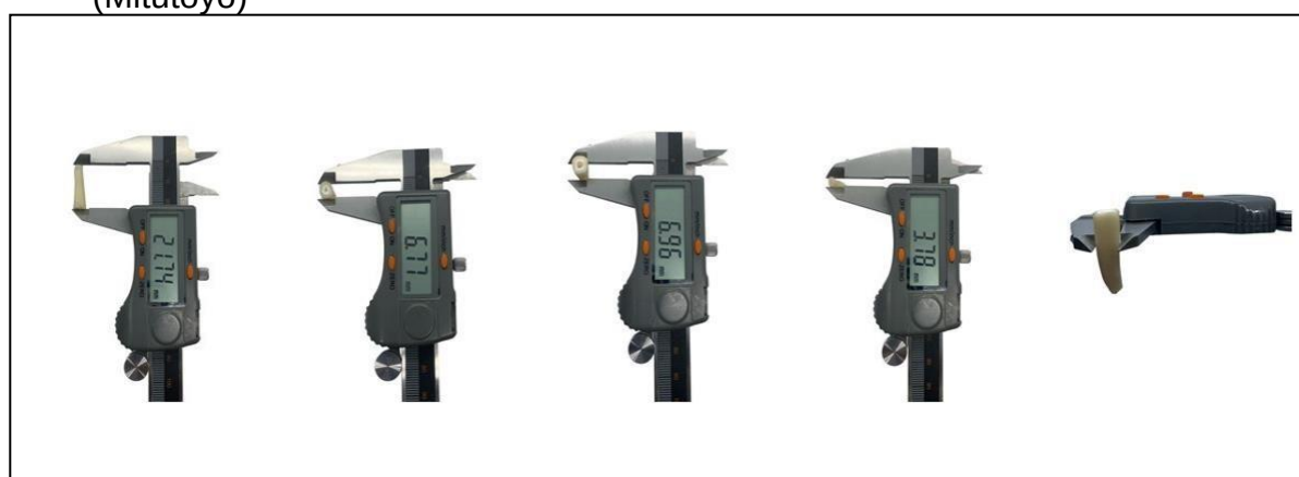
Figura 03 - Mensuração da raiz bovina com auxílio do paquímetro digital (Mitutoyo)
