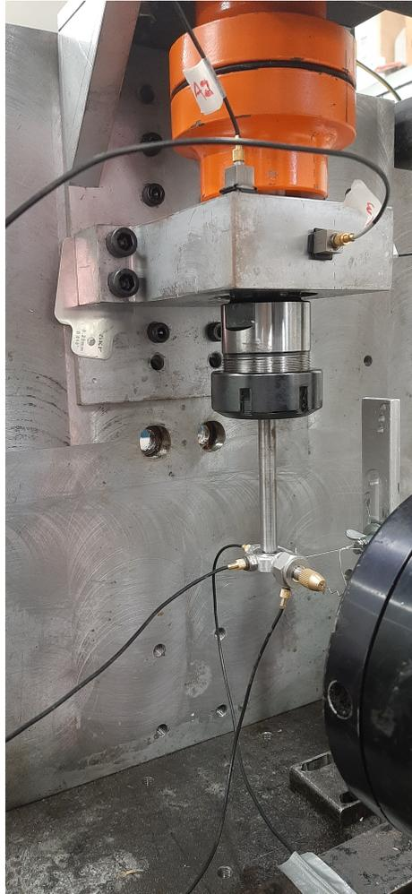
Figura 4.7: Detalhe da montagem da barra e da disposição dos transdutores.
