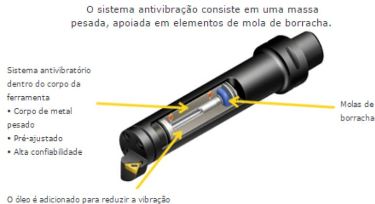
Figura 2.15: Partes do sistema antivibração SILENT TOOLS. Fonte: (SANDVIK)
