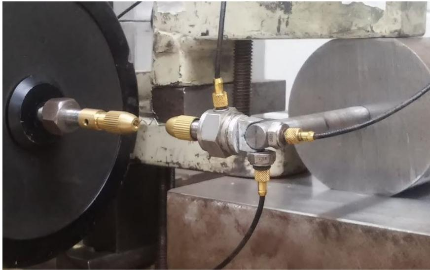
Figura 4.3: Detalhe da fixação dos transdutores à barra.
