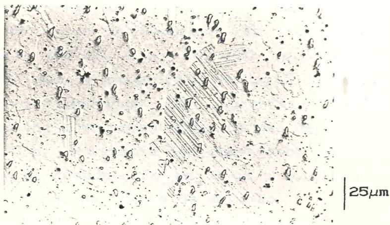
Figura 4.1 - Micrografia da liga de composição nominal  $\text{Fe}_{17}\text{Nd}_2$  (10,5 % at.Nd) após tratamento térmico a  $950^\circ\text{C}$  por 120 h.
