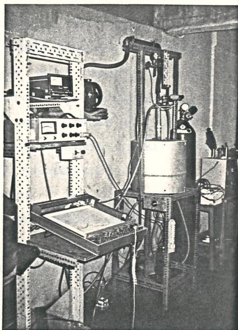
Figura 3.4 - Vista do equipamento de Análise Térmica Diferencial.
