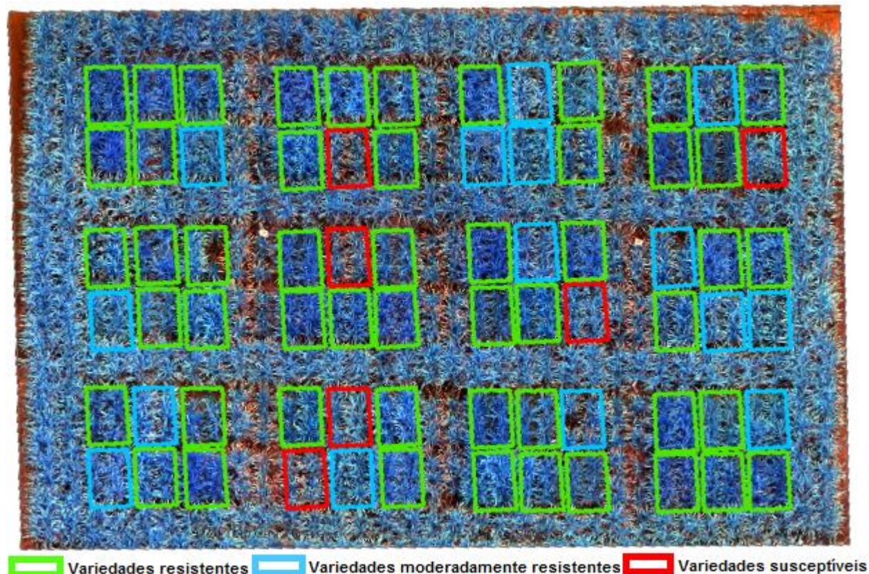
Figura 10. Amostras rotuladas com a classe final de resistência geral às ferrugens alaranjada e marrom em imagem com composição das bandas do vermelho, NIR e Rededge aos 195 DAP.
