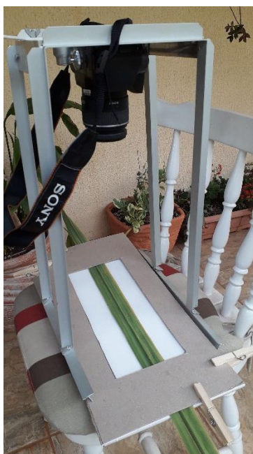
Figura 32. Suporte para câmera utilizado para aquisição de imagens de folhas de cana-de-açúcar infectadas.
