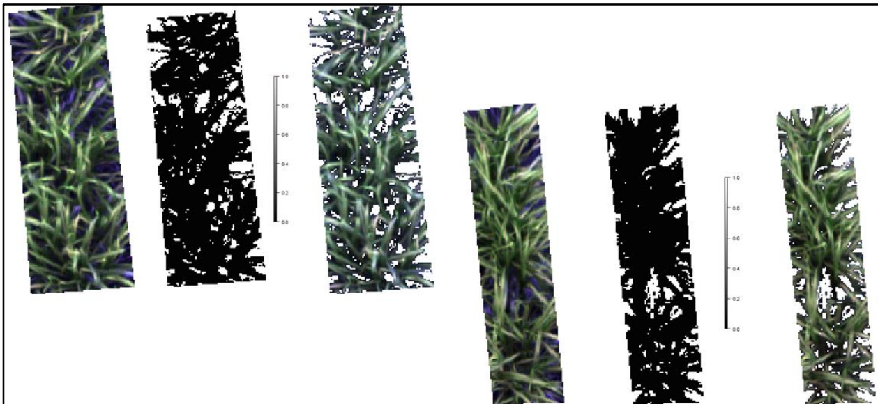
Figura 4. Exemplos de máscaras para separação solo/vegetação das linhas de plantio feita por meio da definição do limiar de 30% de refletância no Índice de Folha Verde (GLI).
