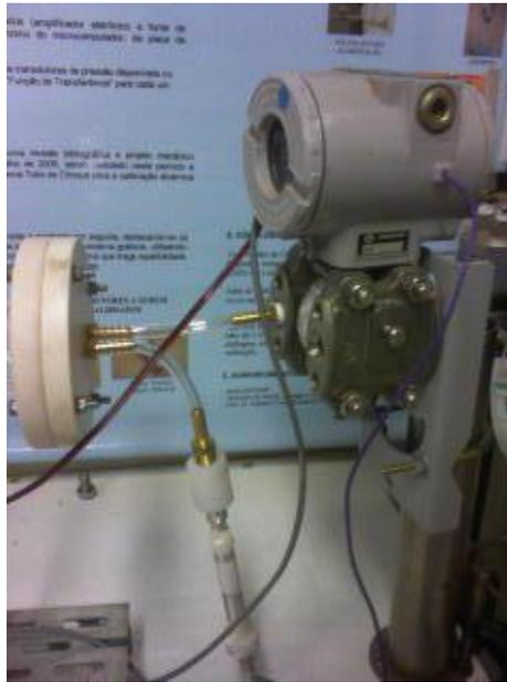
Figura 3.14 Flange de instalação dos sensores para determinação das características dinâmicas do sensor SMAR LD301 – D2
