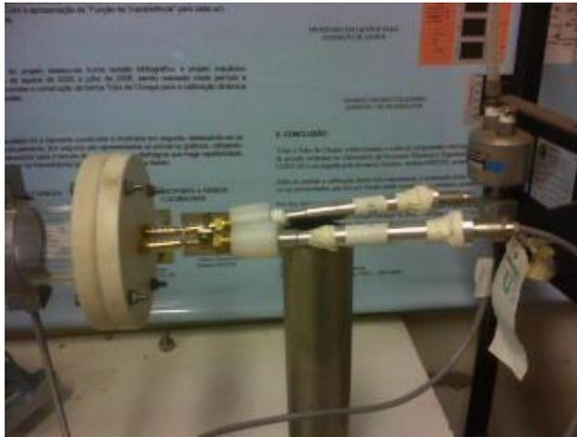
Figura 3.11 Flange de instalação dos transdutores de pressão para estudo da influência das características da tomada de pressão.
