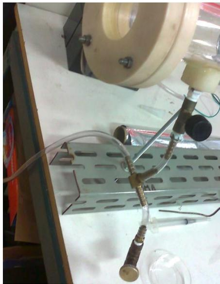
Figura 3.3 Configuração da alimentação de ar no tubo de rarefação.
