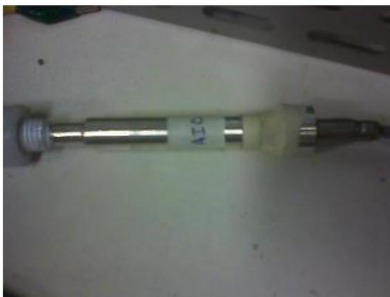
Figura 3.10 Suporte de alumínio para os sensores de pressão
