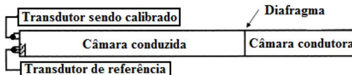
Figura 2.7 Diagrama esquemático do tubo de choque
