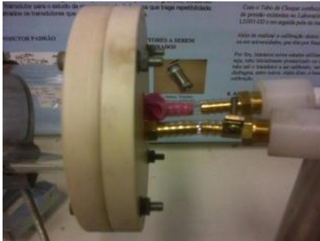
Figura 3.13 Instalação do filtro nos flanges
