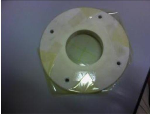
Figura A2.2 Instalação do diafragma no flange
