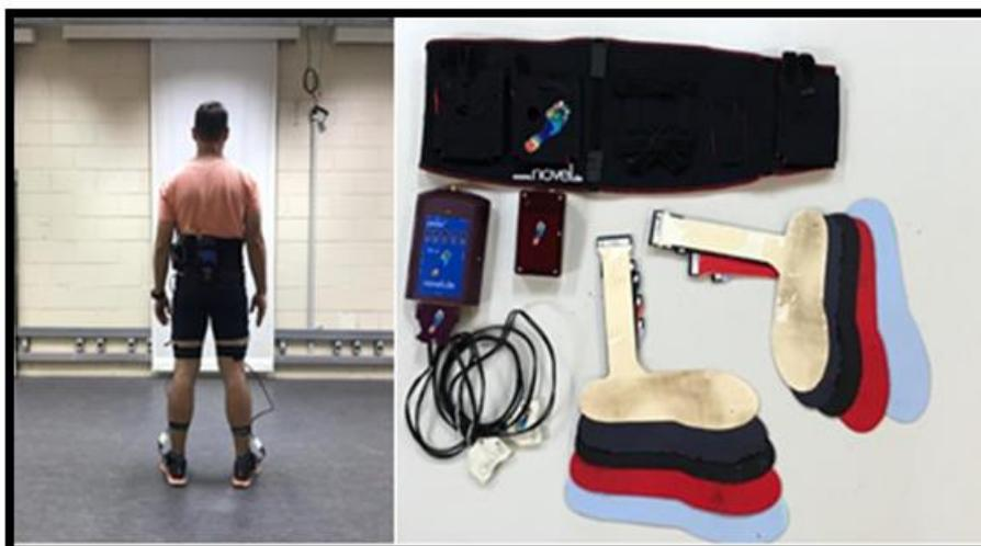
Figura 2: Fixação do Sistema Pedar® -X (Novel, Alemanha) e palmilhas instrumentadas.
