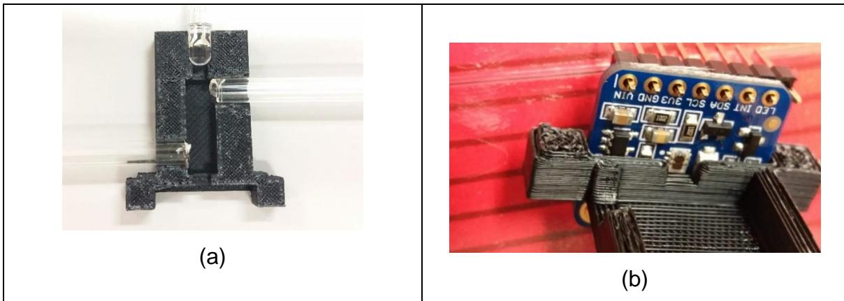
(a) Registro fotográfico do corte transversal do sensor impresso em ABS, possibilitando visualizar os tubos de acesso à câmara interna e a posição prevista para o *Light Emitting Diode Red, Green and Blue* (LED RGB). (b) Registro fotográfico do posicionamento previsto para o fotodetector. Fonte: Acervo do autor (2021).
