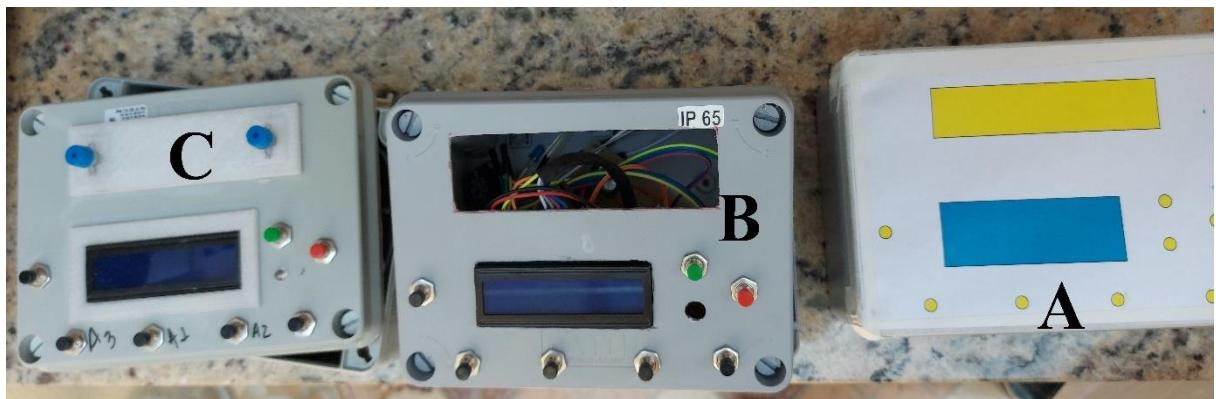
Em (A), pode ser observado o plano de corte da caixa. No item (B), é mostrada a caixa com os componentes sendo afixados. Em (C), são mostradas a caixa com o sensor afixado e a moldura do LCD. Fonte: Acervo do autor (2021).
