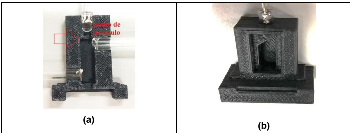
Legenda: (a) Registro fotográfico do corte transversal do sensor impresso em ABS, destacando, em vermelho, o ponto de acúmulo de bolhas. (b) Registro fotográfico do sensor com a estrutura projetada no local próximo ao LED para facilitar a saída das bolhas de ar. Fonte: Acervo do autor (2021).
