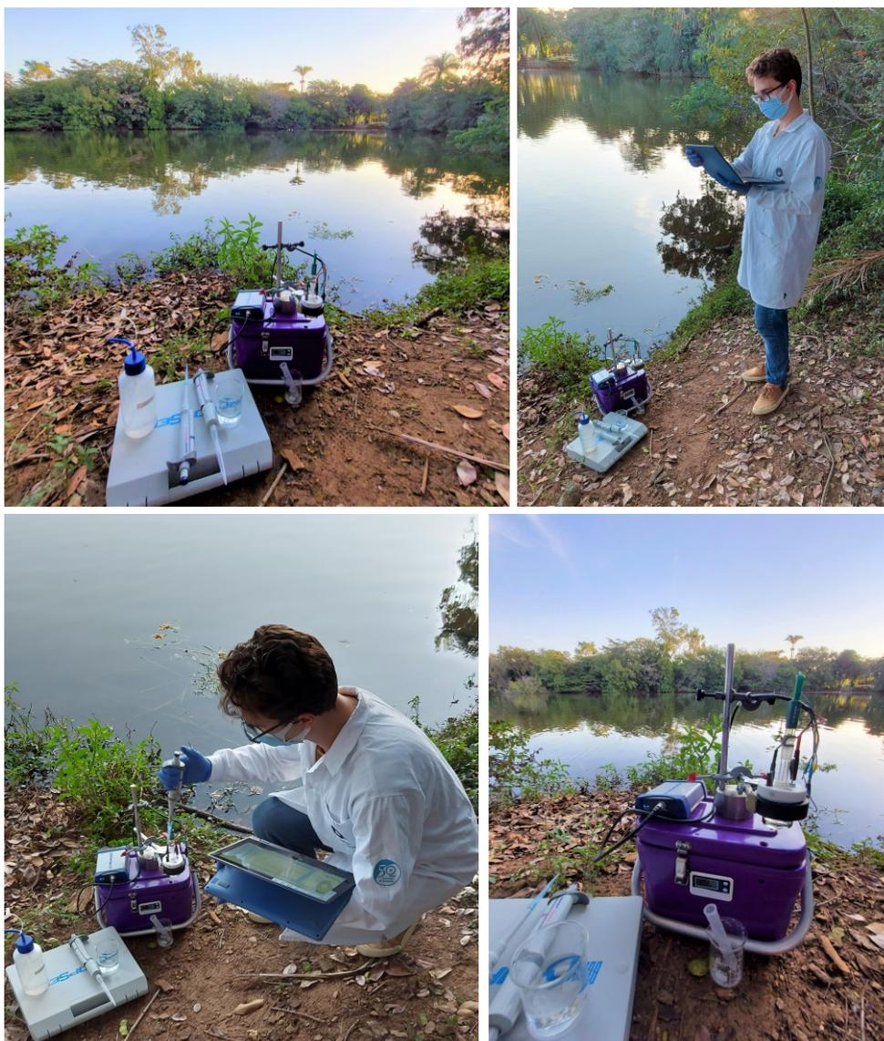
**Figura 48.** Fotografias mostrando a utilização do sistema portátil operando com o potenciostato  $\mu$ STAT 400 controlado por notebook com conexão Bluetooth a beira do lago, evidenciando a potencial aplicação dessa plataforma para monitoramento *in situ* de amostras ambientais.
