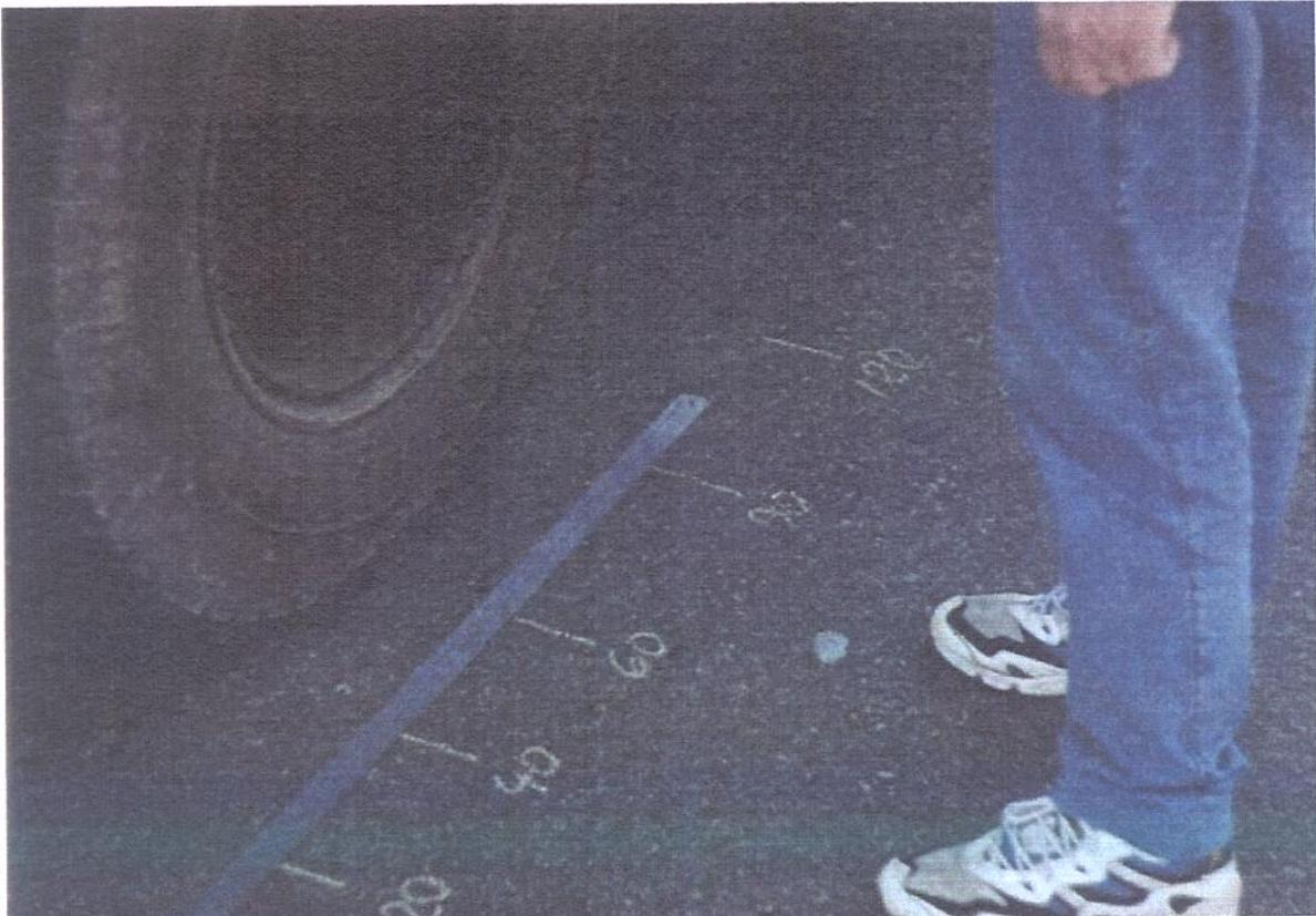
Figura 3 – Demarcação no pavimento para a determinação da bacia de deslocamento
