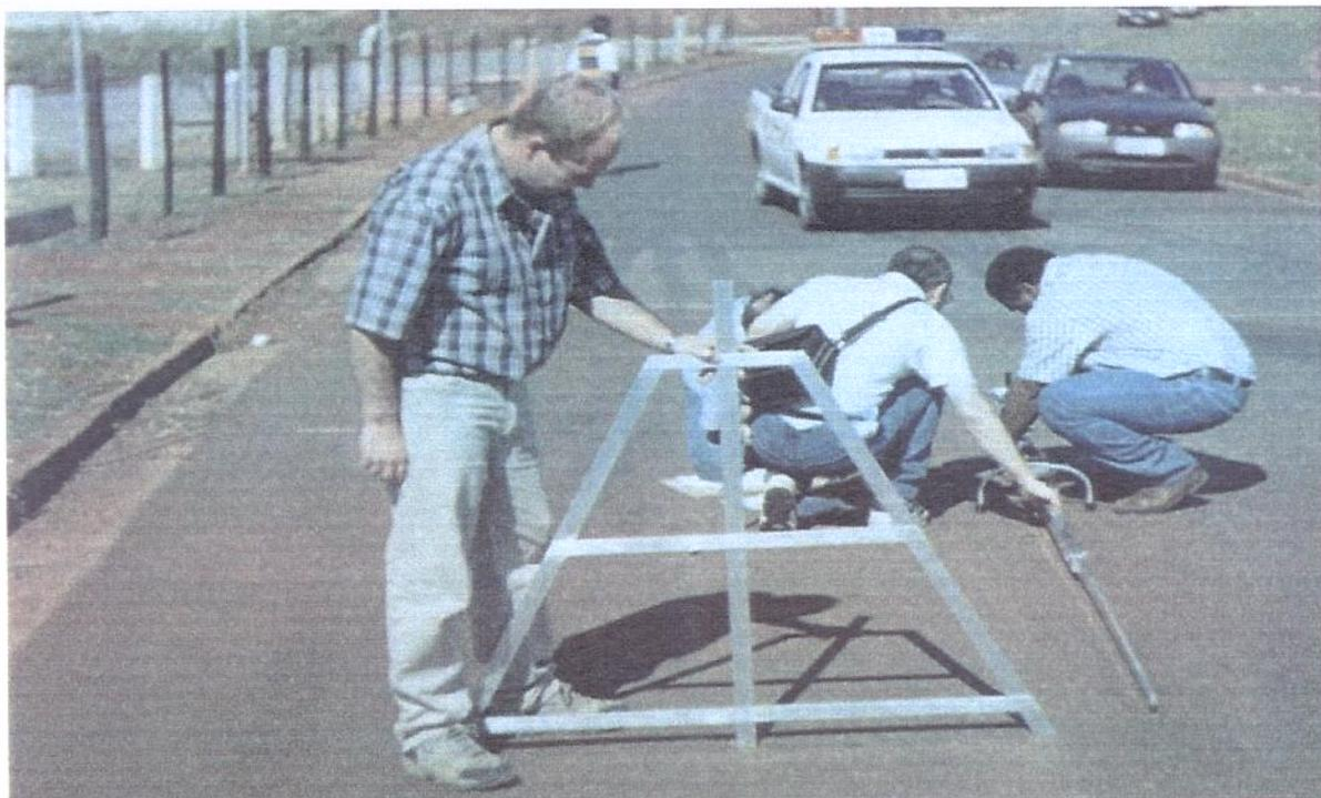
Figura 6 – Medição da deformação permanente do pavimento
