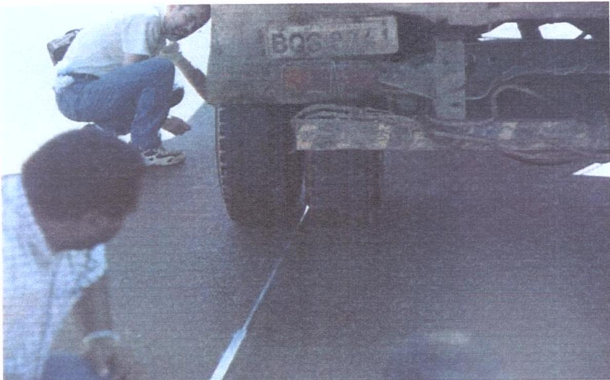
Figura 4 – Determinação da deflexão sob a carga traseira do caminhão (L0)
