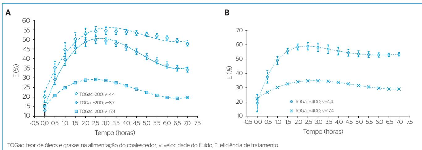
**Figura 4** - Eficiência de tratamento ao longo do tempo (A) para teor de óleos e graxas na alimentação do coalescedor de 200  $\text{mg.L}^{-1}$  e valores de velocidade superficial de 4,4; 8,7 e 17,4  $\text{m.h}^{-1}$  e (B) para teor de óleos e graxas na alimentação do coalescedor de 400  $\text{mg.L}^{-1}$  e valores de velocidade superficial de 4,4 e 17,4  $\text{m.h}^{-1}$ .
