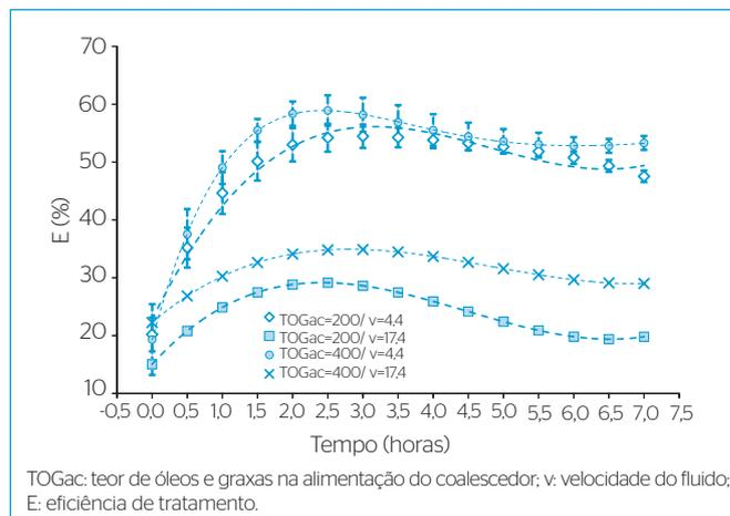
**Figura 3** - Influência do valor de teor de óleos e graxas na alimentação do coalescedor (200 e 400 mg.L<sup>-1</sup>) na eficiência de tratamento ao longo do tempo, para valores de velocidade do fluido de 4,4 e 17,4 m.h<sup>-1</sup>.
