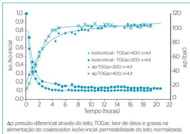
**Figura 2** - Evolução da pressão diferencial e da permeabilidade do leito do coalescedor ao longo do tempo para teor de óleos e graxas na alimentação do coalescedor de 200 e 400 mg.L<sup>-1</sup> e velocidade do fluido de 4,4 m.s<sup>-1</sup> (Qac=30 L.h<sup>-1</sup>).
