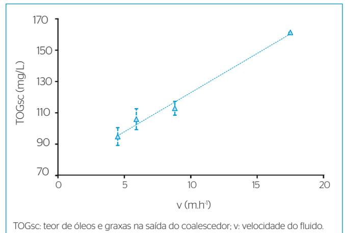
**Figura 5** – Variação do teor de óleos e graxas na saída do coalescedor em função da velocidade para teor de óleos e graxas na alimentação do coalescedor de 200  $\text{mg.L}^{-1}$  decorridas 4 horas de teste.
