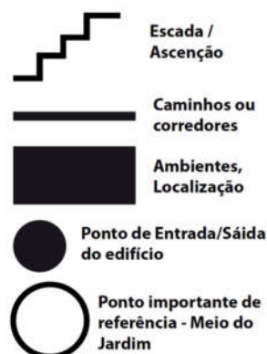
Figura 2: Síntese da simbologia de orientabilidade adotada no fluxograma tátil.
