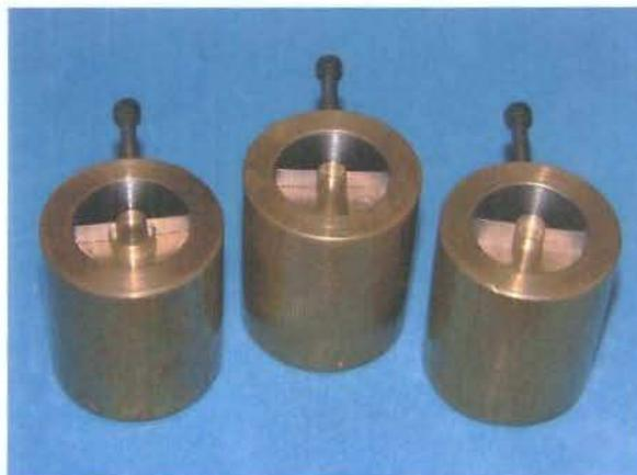
**Figura 2** – Matrizes metálicas bipartidas com 2, 4 e 6 mm de altura.
