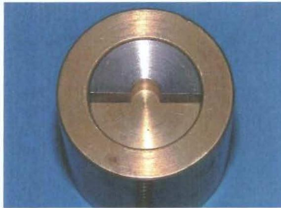
**Figura 1** – Matriz metálica bipartida cilíndrica com 5 mm diâmetro.
