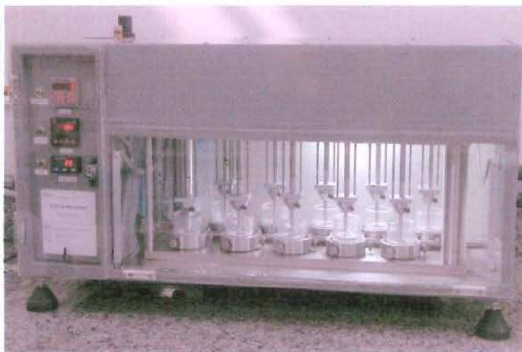
Figura 9- Envelhecimento artificial através de fadiga mecânica em Máquina de Ciclagem Mecânica.
