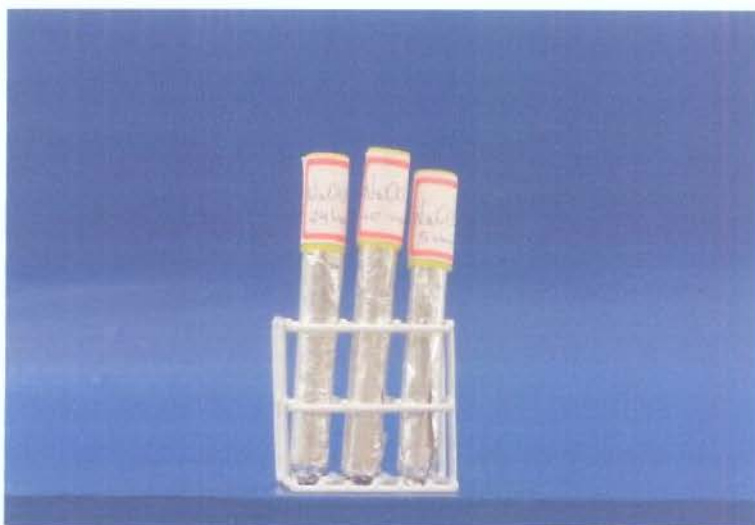
Figura 1 – Tubos de ensaio contendo limas 25/06 do sistema Hero 642 envolvidas com papel alumínio para proteção contra luz.
