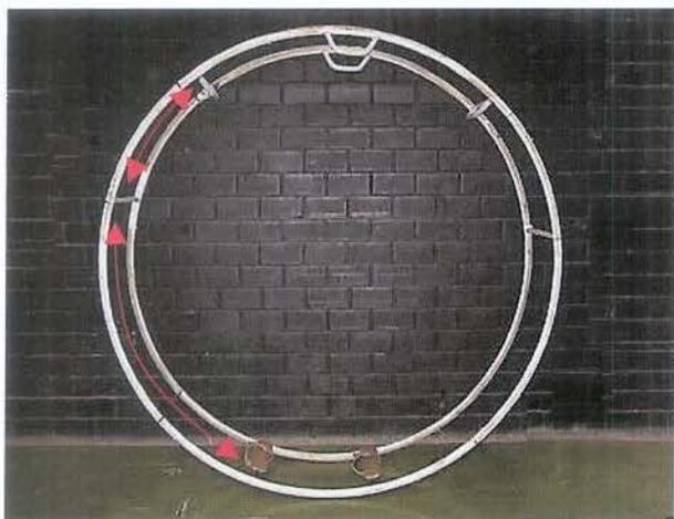
FIGURA 8: Roda Montada Errada.
