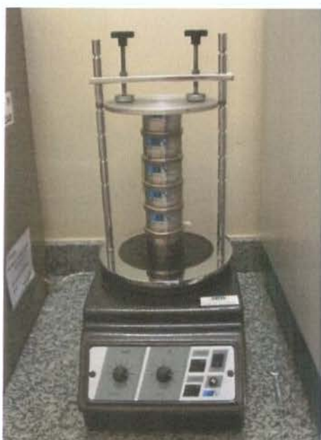
Figura 3 – Peneiras acopladas sobre o vibrador
