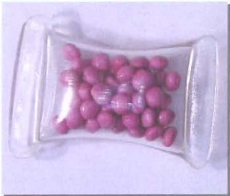
Figura 6 – Cápsula de PVC contendo os grânulos de fucsina
