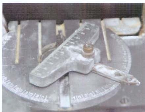
Fig.8-Base horizontal com arco graduado e acessório de regulação angular e linear
