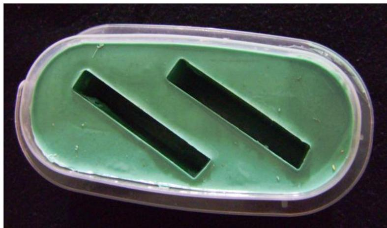
Fig. 2 - Molde onde foi vertido a resina fotoelástica
