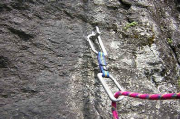
Figura 10: A imagem mostra a costura no P e a corda na costura, dessa maneira o escalador estará seguro
