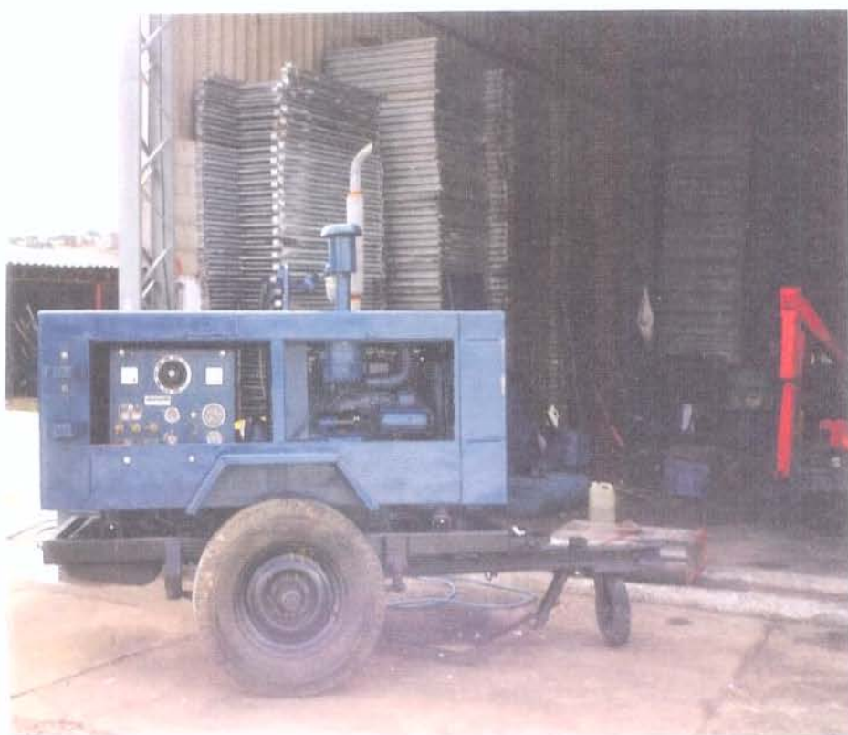
Moto-geradora Diesel em reforma no primeiro plano, estoques de andaimes empilhados ao fundo
