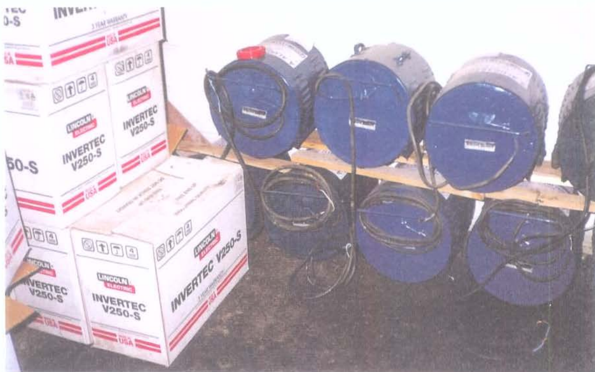
Inversores Lincoln 250 amperes novos, encaixotados, transformadores 250 amperes antigos, à direita
