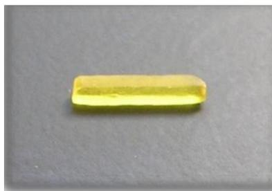
Figura 1. Barra de adesivo utilizada no ensaio de resistência a flexão.
