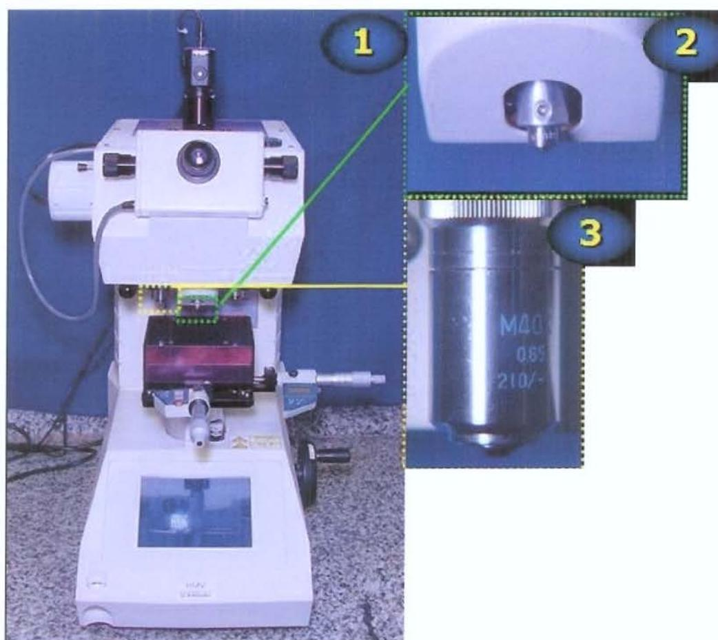
Figura 2 – (1) Aparelho HMV-2 para ensaio de dureza; (2) – ponta edentadora utilizada para aplicação de carga para dureza Knoop; e, (3) – lente de aumento de 40X utilizada na leitura de dureza.
