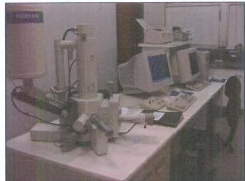
Figura 16. Microscópio Eletrônico de Varredura.
