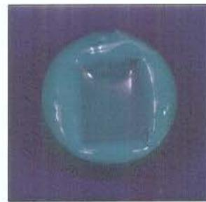
Figura 13. Molde vazado em resina epóxica para obtenção da réplica.
