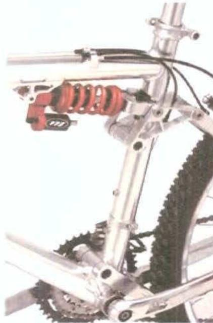
Suspensão traseira e dianteira. Detalhe da suspensão traseira.
