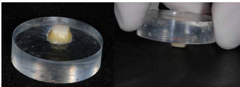
Figura 3: Planificação da superfície de esmalte com lixas de carbeto de silício de granulação crescente (#600 e #1200).
