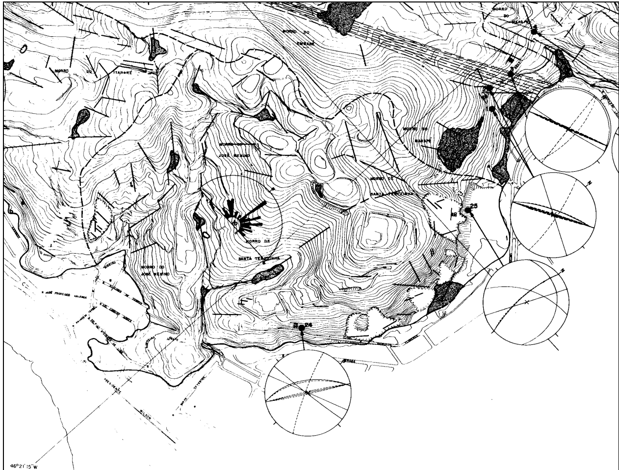
Figura 14. Mapa estrutural do Morro Santa Terezinha contendo os sistemas preferenciais persistentes de descontinuidades e a rosácea de fotlineamentos dessa unidade de análise (SANTORO et. al., 1979)
