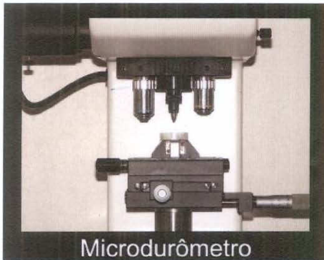
Figura 5 – Microdurômetro utilizado (FM-Equilam Indústria e Comércio Ltda)
