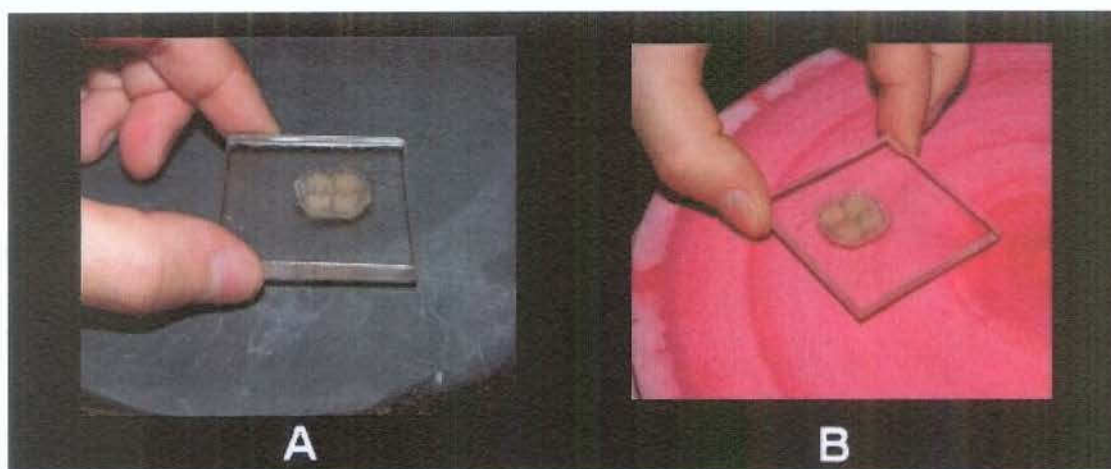
Figura 3 – Procedimento de acabamento e polimento: acabamento utilizando lixas de óxido de alumínio (A); Polimento final com discos de feltro (B).
