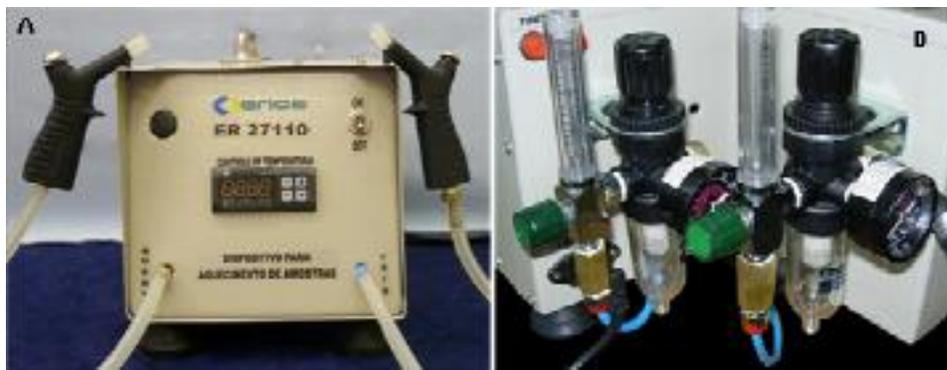
Figura 5: A- Vista Frontal: Dispositivo portátil para o aquecimento de ar utilizado neste estudo; B- Vista Traseira: Pressão (5 Psi) e vazão de ar (15l/min) ejetadas controladas e constantes na saída do dispositivo).
