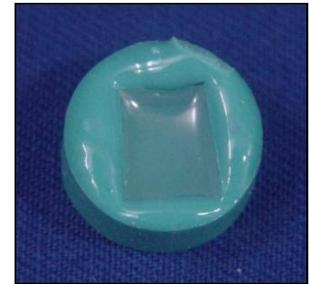
Figura 6. Molde vazado em resina epóxica para obtenção da réplica.
