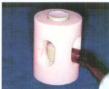
Figura 6 – Posicionador de resina acrílica com corpo-de-prova no orifício central, e a fotoatuação do cimento sendo realizada pelo orifício lateral.
