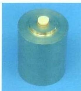
Figura 5: Disco de cerâmica posicionado na matriz metálica.
