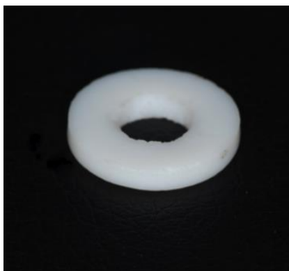
Figura 4. Matriz circular de teflon utilizada para confecção dos corpos-de-prova.
