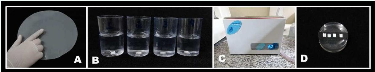
Figura 4 - (A) Polimento do espécime de dentina; (B) Espécimes de dentina imersos em água deionizada; (C) Aparelho de ultrassom utilizado para remoção de impurezas dos espécimes; (D) Espécimes fixados em *stub* por fita carbono dupla-face.
