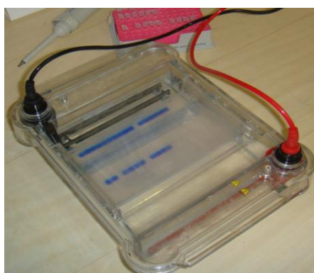
Figura 3 – Cuba de eletroforese contendo o gel com as amostras nos poços.
